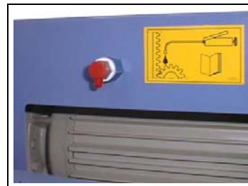
Fig. 33 Graissage de la crémaillère
